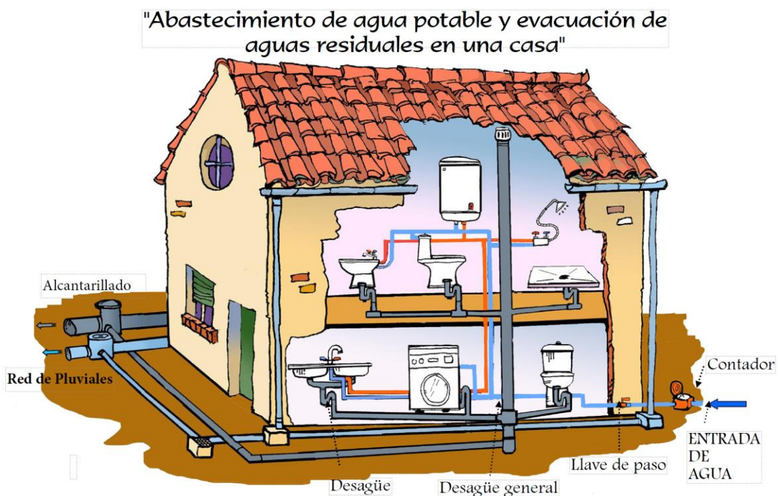
Figura 2.- Representación esquemática del abastecimiento de agua potable y evacuación de aguas residuales en una casa tipo; se muestra la entrada de agua potable que alimenta las redes de agua caliente y fría. Tras su paso por inodoros, lavabos, duchas y electrodomésticos, las aguas residuales urbanas se evacúan mediante las tuberías de desagüe, que vierten a una red específica, el alcantarillado; también se muestra la evacuación de aguas pluviales, en este caso separadas, que vierten a la red de saneamiento de aguas pluviales.
